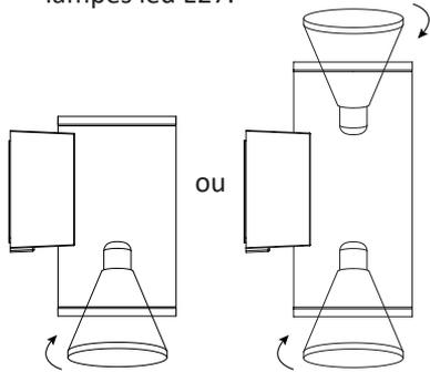
**5. Remettre le(s) diffuseur(s) en le(s) vissant à l'aide d'un tournevis et fixez l'applique au mur.**
